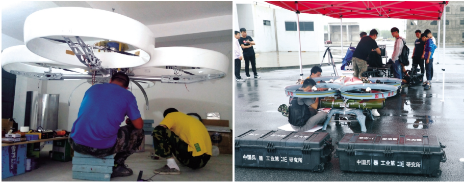
消防无人机的检查、调试
